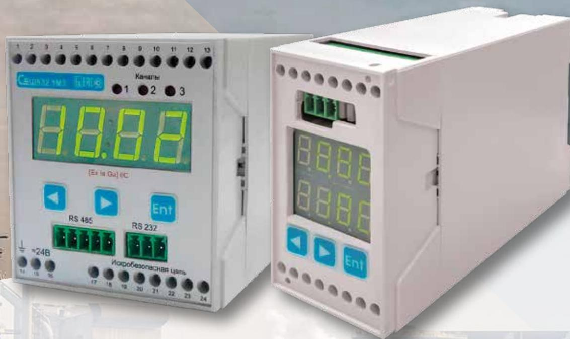
Измерительные преобразователи модульные (далее — ИПМ) предназначены для преобразования сигналов от датчиков температуры (ТС, ТП) и преобразователей с унифицированными выходными сигналами (мВ, В, мА, Ом, кОм) в токовые сигналы тока 0..5, 0..20 и 4..20 мА.
