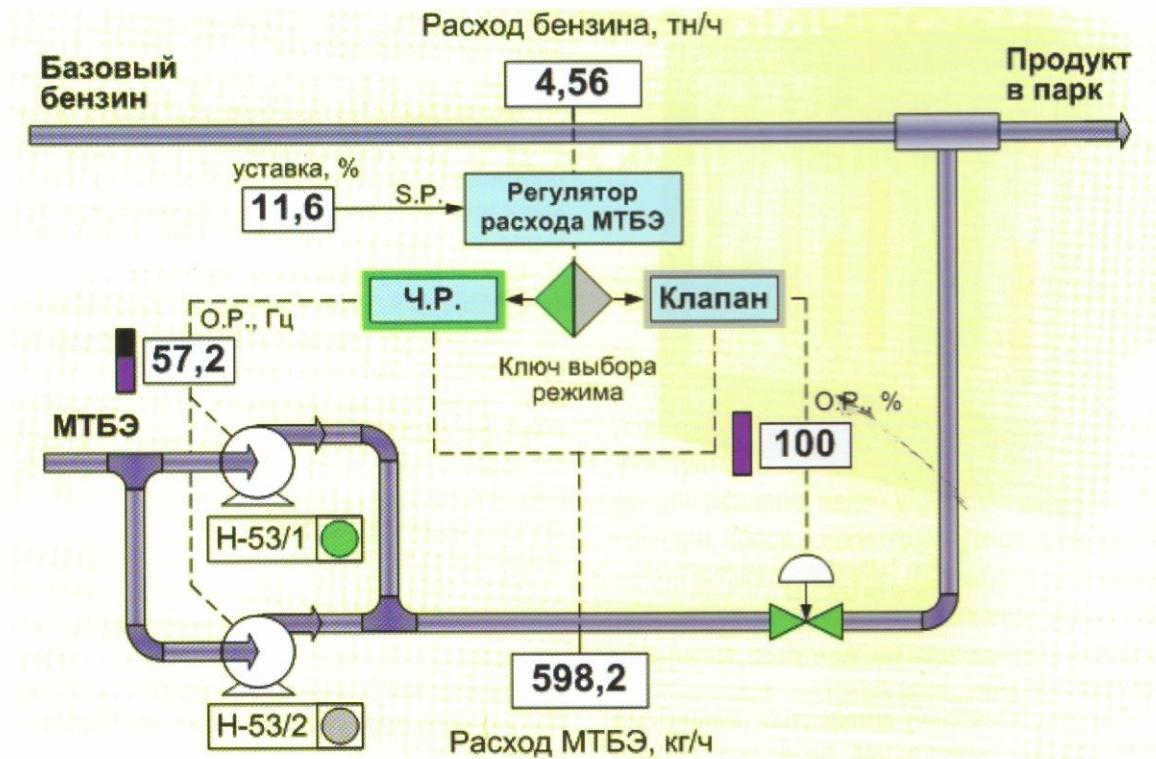
Рис. 2. Мнемосхема узла дозировки МТБЭ
