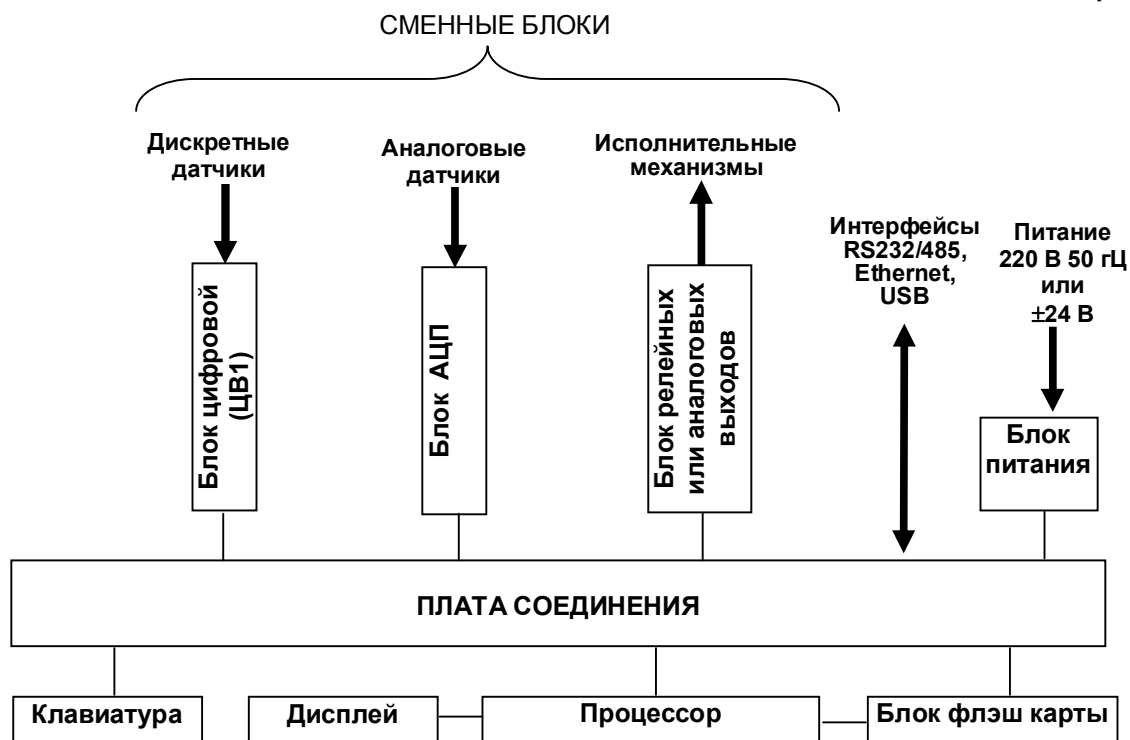
Рисунок 3.1 - Структурная схема прибора
