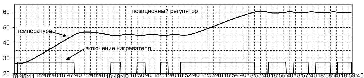
Рисунок 1 - Регулирование температуры объекта позиционным регулятором прибора Ш932.9А. Транспортное запаздывание объекта невелико.
