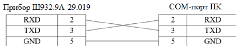
Рисунок В.3 – Подключение к интерфейсу RS-232
