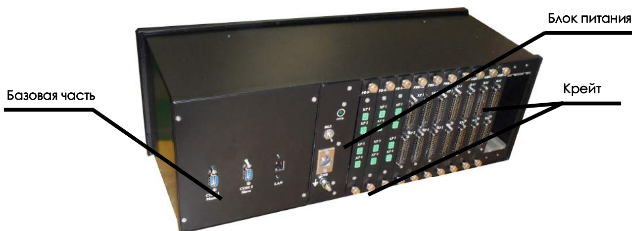
Рисунок 3.4 - Внешний вид контроллера щитового исполнения с блоками ввода/вывода со стороны задней панели
