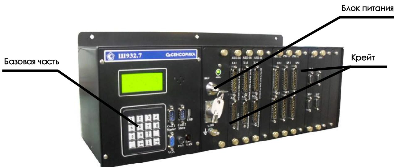
Рисунок 3.2 - Внешний вид контроллера шкафного исполнения со стороны лицевой панели
