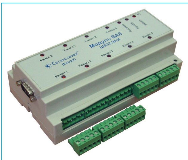
Рис. 3. Модуль аналогового ввода ВА8.
