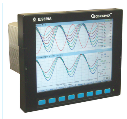
Рис. 1. Видеографический регистратор Ш932.9А-29.016
