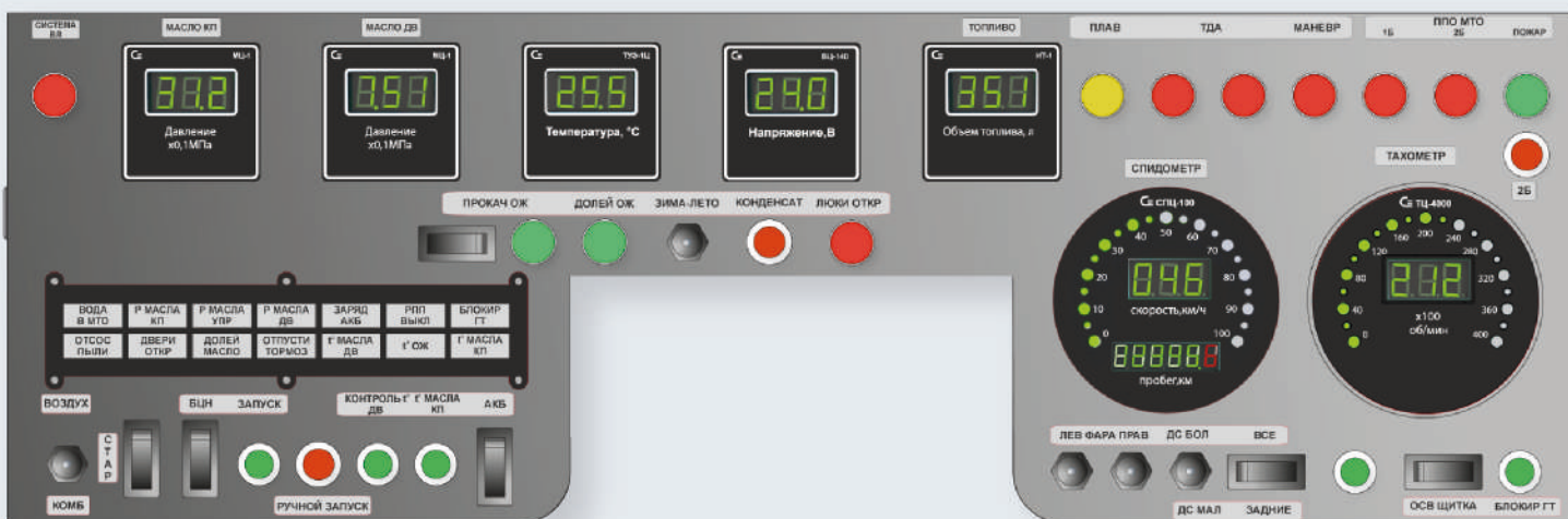
Рис. 2 Щиток с цифровыми приборами
