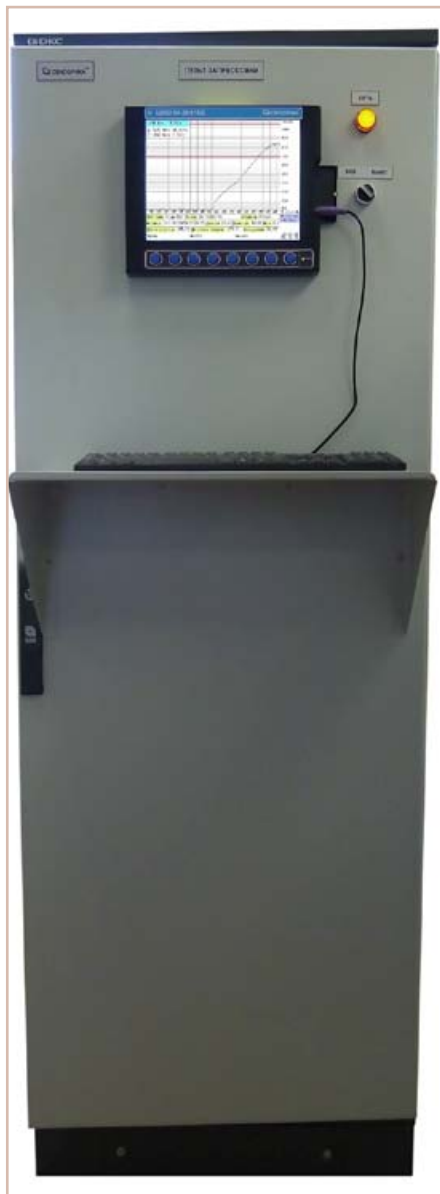
Рис. 1. Шкаф с установленным прибором Ш932.9А и клавиатурой
