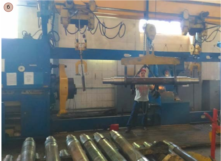
Рис. 3. Пресс ПА-6738 (а) на участке формирования колесных пар (б)
