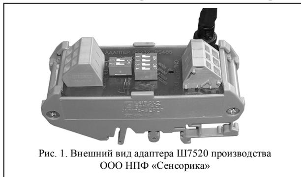
Рис. 1. Внешний вид адаптера Ш7520 производства ООО НПФ «Сенсорика»
