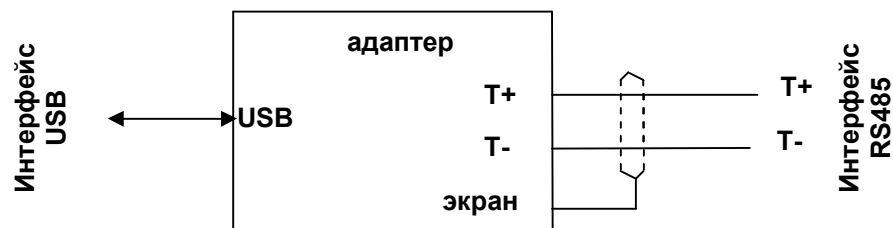
Рисунок 5.1 – Внешние подключения к адаптеру
